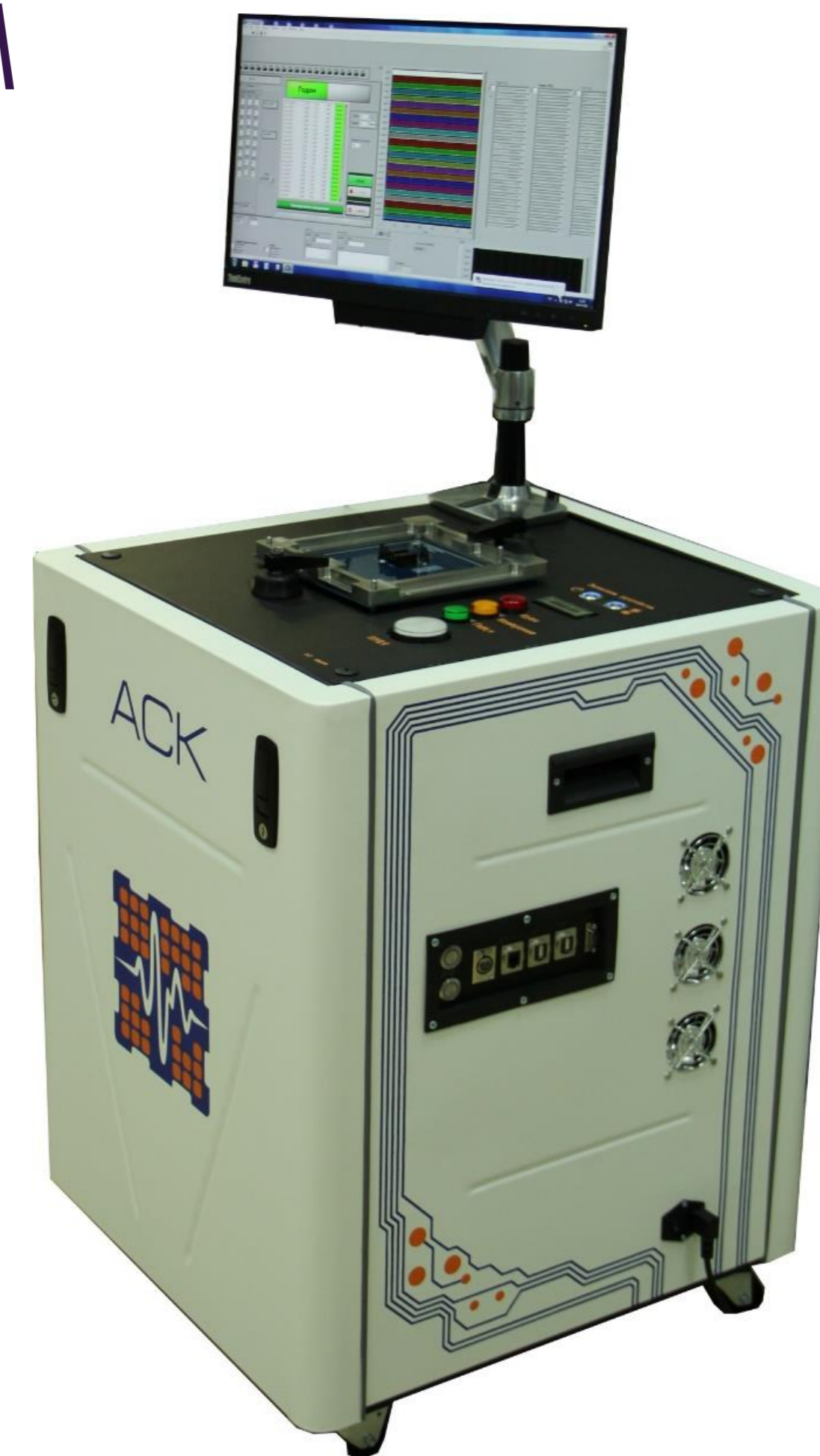
Тестер ACK M 3128 как комплексное АРМ (тестер смешанных цифро-аналоговых сигналов)
